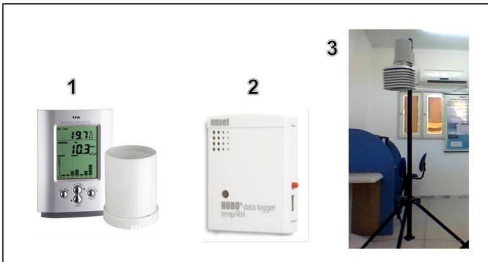
Figura 04 – Instrumentos para o monitoramento hidroclimático na região serrana de Portalegre, Martins e adjacências. 1 – Pluviômetro digital TFA; 2 – Termohigrômetro digital HOBO data logger; 3 – Instrumentação montada em uma base metálica (tripé).
