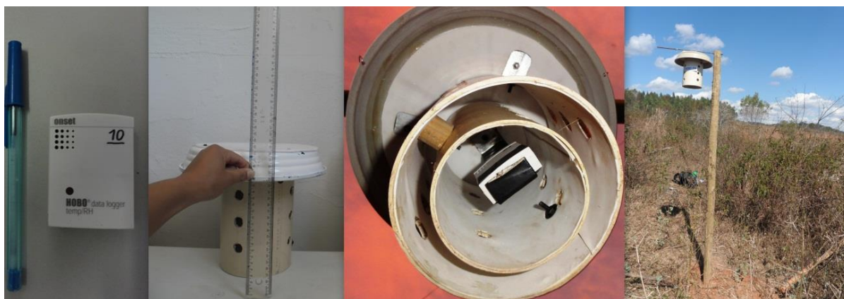
Figura 04. Datalogger HOBBO e mini abrigo meteorológico alternativo fixados em campo Fonte das imagens: Rafael de Souza Alves, 2013.
