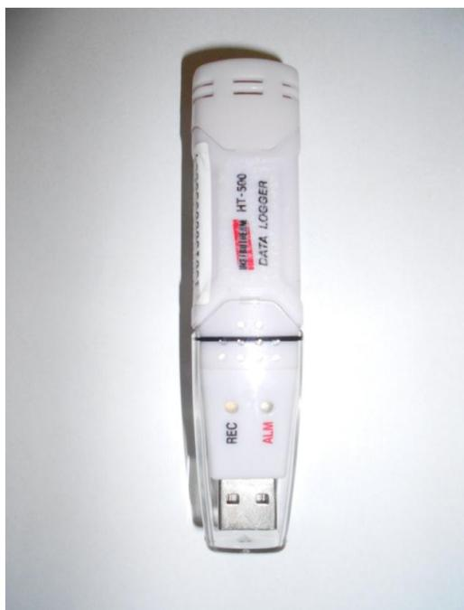
Figura 02 – Termohigrômetro (Modelo HT – 500)
