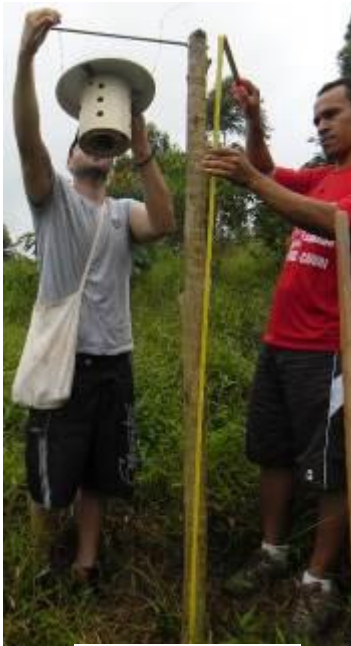
Figura 03: Instalação e fixação dos mini-abrigos meteorológicos em
