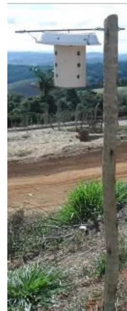
Figura 03: Instalação e fixação dos mini-abrigos meteorológicos em
