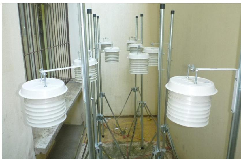
Figura 05 - Abrigos confeccionados fixados aos tripés galvanizados.
