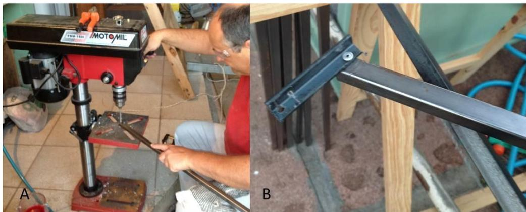
Figura 01 – A-Perfuração de perna do tripé e B-Rebitamento e furação da base da perna do tripé.
