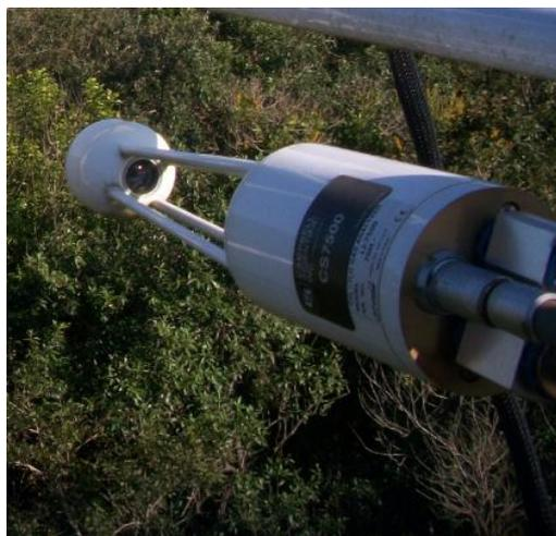
Figura 02 – Analisador de gás infravermelho, modelo LI-7500 (Campbell).
