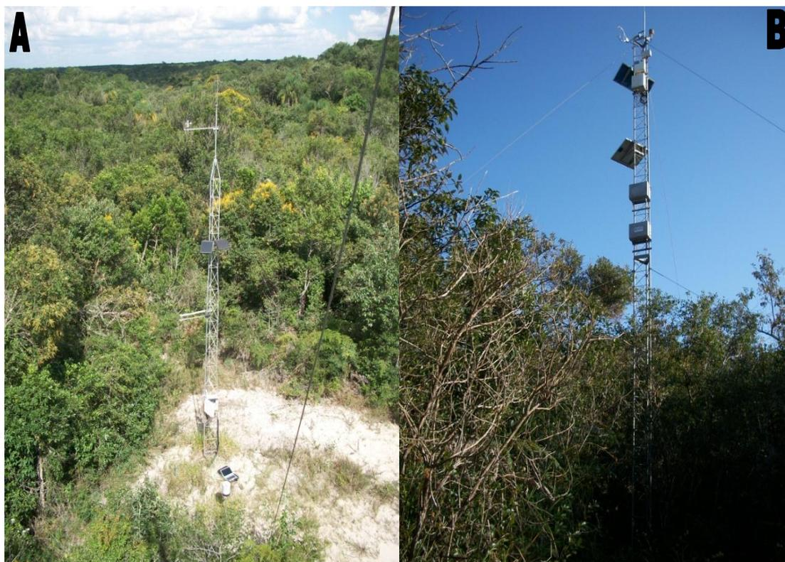
Figura 01 – Torres da estação micrometeorológica instalada no cerrado da Estação Ecológica de Assis.
