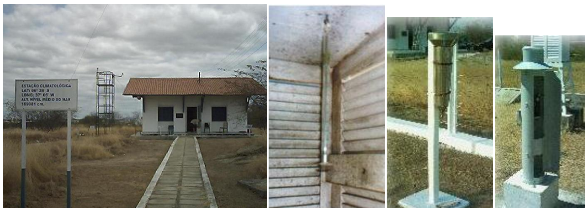
Figura 02: Mosaico de imagens mostrando da esquerda para a direita: a casa sede da estação climatológica do Seridó, o evaporímetro de piche, o pluviômetro e o pluviógrafo. Fonte: Ferreira Et al , 2013; arquivo dos autores.
