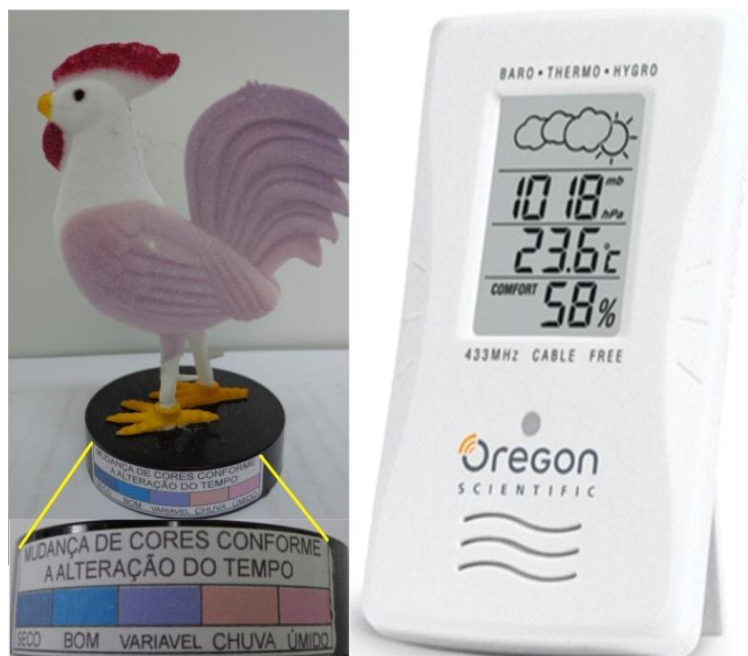
Figura 02. Galinho do tempo e o baro-termo-higrômetro utilizados nas oficinas
